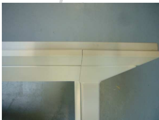
Imagen 1. Detalle de la unión entre los componentes M181001_C1 y C2
